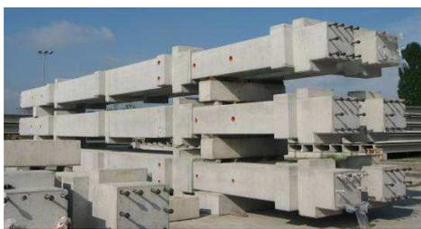
Figura 15. Stoccaggio pilastri prefabbricati
